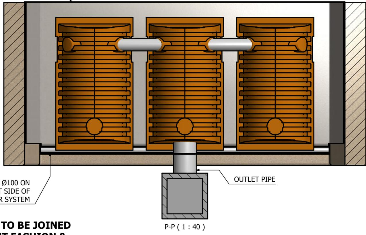
**NOTE: ALL LINER TO BE JOINED IN A WATER TIGHT FASHION & INSPECTED PRIOR TO BACKFILL.**
